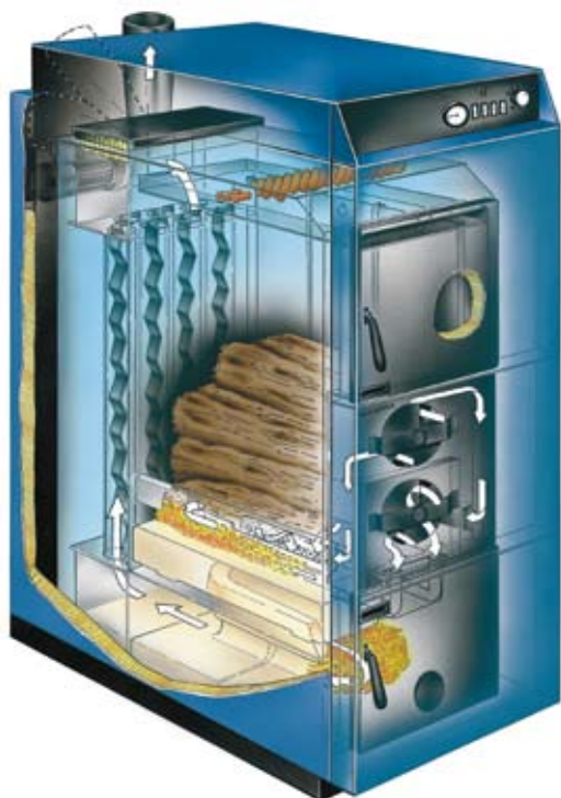
Røntgenbillede af en manuelt fyret kedel.
