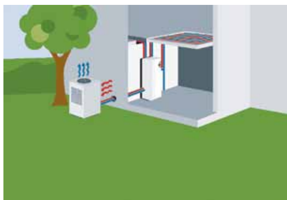
Luft/vand varmepumpe er lidt dyrere i drift, for energien i luften er ikke særlig høj om vinteren, hvor der kræves mest varme.
